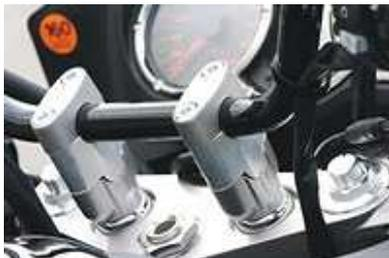
**Pour les supports de guidon monobloc** usinés dans la fonderie du té supérieur, il suffit de se procurer des cales qui s'intercalent entre le guidon et le support du té. Touratech, par exemple, en commercialise de très bonne facture pour de nombreux modèles (relevez les dimensions de vos supports : diamètre de guidon et entre axe des vis de bride).
