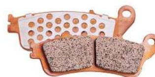
Attention, ne jamais monter de plaquettes "métal fritté" sur un disque en fonte : ce dernier ne supporte pas le coefficient de frottement et le métal est rapidement détrempe puis détérioré. Dans ce cas, choisir de bonnes plaquettes organiques "kevlar" qui donnent de bons résultats également.
