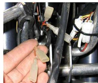
Le circuit du GPS doit être impérativement muni d'un fusible (1 A / 250V). Le mieux est de construire un circuit propre au GPS, éviter d'intercaler une prise type allume-cigare qui ne fait qu'ajouter un risque de problème électrique.
