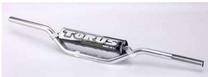
Il peut être intéressant de remplacer le guidon d'origine de votre trail pour des raisons de solidité et/ou d'ergonomie.
