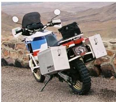
Pour les voyages au long cours, en autonomie totale, le système de coffres ou de valises rigides est la plus adaptée, en terme de capacité d'emport et de robustesse (ce système doit toutefois être pensé spécifiquement pour une utilisation « raid »). La solution ultime, mondialement reconnue par les globetrotters du globe, est le système de caisses Zega en aluminium (conçu et commercialisé par Touratech).
