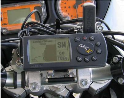
Le GPS doit être positionner le plus près possible du champ de vision habituel, assis sur la moto. De ce fait, le montage du GPS sur la barre centrale du guidon (qui est, de loin, la solution la plus simple) n'est pas idéale : elle suppose de baisser vraiment le regard pour consulter le GPS et de quitter le chemin de vue. C'est dangereux. *(Photo Rémi Antoine)*
