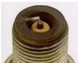
Si l'isolant de l'électrode centrale est sec, marron clair voir très clair et le culot est couvert d'un dépôt de suit noire et sèche, c'est correct
