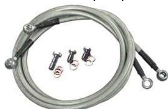
Cette amélioration de l'origine consiste simplement au montage d'une durite type « Aviation » (tube téflon serré dans un tissu de fil d'inox tressé), de purger parfaitement le circuit de liquide de frein (lequel doit être de bonne qualité) et d'adapter des plaquettes un peu plus « méchantes » que les garniture standard organique. (*Photo Touratech*)
