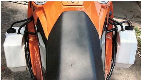
Les **réservoirs additionnels en plastique** : ils sont généralement fixés sur le porte bagage et sont munis de supports d'encrage permettant de les boulonner à la moto. Ils sont généralement aussi encombrants qu'un jerrycan... Cependant, on peut parfois les intégrer au mieux à la moto, comme par exemple en les fixant sur les crash-bars comme sur cette KTM LC8 (photo K2m sur [www.advrider.com](http://www.advrider.com)). Mais attention à la chute...
