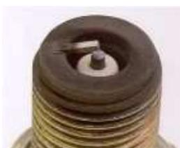
Si l'isolant de l'électrode centrale est blanchâtre, c'est que le gicleur principal est trop petit (trop pauvre).
