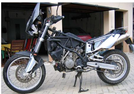
D'origine, hormis les KTM équipée d'une très pratique et très intégrée (elle ne gêne pas la garde au sol) béquille centrale, la plupart des trails ne possède qu'une béquille latérale.
