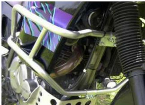
Le montage d'un crash-bar (barres de protection des flancs de la moto) est très conseillé. Le crash bar doit présenter les caractéristiques suivantes :
