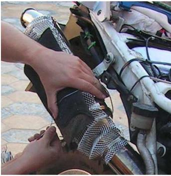
Un exemple de protection contre la chaleur du pot : de l'aluminium déployé plié en « accordéon » fixé sur le silencieux avec 3 colliers à vis complété d'un morceau de moquette de R12 Bérbère fixé avec deux fils de fer afin de protéger les sacoche du frottement. Ce montage s'est révélé totalement efficace sur 2500km de pistes et routes marocaines.
