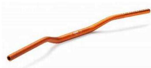
Certains modèles européens (notamment KTM LC4 & LC8) sont munis de guidon à diamètre variable (extrémité des branches plus fine que le milieu) sans barre centrale (Magura X-Line ou Renthal ProTaper). Ce type de guidon est très solide, mais il ne s'adapte que sur des potences spéciales, leur diamètre étant de 28 mm.
