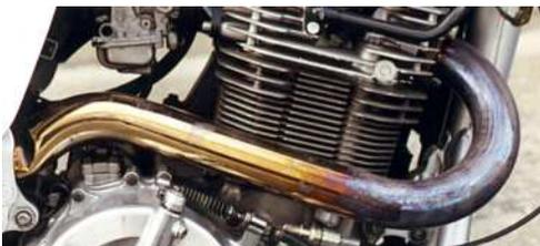
Il peut être intéressant, dans certains cas, d'adapter un coude d'échappement dit "gros diamètre" en place de l'origine. Cette transformation n'est vraiment "rentable" que si le diamètre interne du coude d'origine est nettement plus petit que le diamètre du conduit d'échappement de la culasse.
