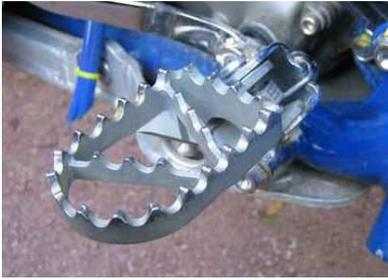
Les cales-pieds large, comme ceux monté en série sur toutes les KTM, permet un pilotage debout sur les cales-pieds très confortable dans la mesure où les pieds repose sur une plus grande surface. L'idéal est de les remplacer par des cales-pieds larges en accessoire (Touratech, Hessler...). *(Photo Hessler Team)*
