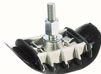
Un gripster est un petit accessoire qui se fixe dans la jante au moyen d'une tige fileté (comme une seconde valve en quelque sorte) et qui permet de serrer le pneu contre la jante et l'empêche donc la jante de tourner dans le pneu lorsque vous êtes en traction avec une pression de gonflage inférieure ou égale à 1 bar.
