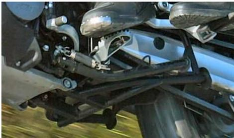
Les modèles ayant été conçus pour recevoir une béquille centrale en option ne présentent pas cet inconvénient. Par exemple, la béquille centrale de la KTM LC8 est un modèle d'intégration : rien ne dépasse sous la plan du sabot, l'ensemble s'intègre parfaitement au châssis et l'équilibre sur la centrale est optimal (en léger appui sur l'avant : graissage de chaîne facilité)
