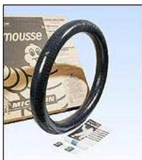
On peut également être tenter de monter des Bib-Mousse. Il s'agit du célèbres produit fabriqué par Michelin et utilisés sur toutes les motos de rally-raid (voire également en enduro) : la chambre à air est remplacée par un "boudin" de mousse conférant au pneu l'équivalent d'une pression de l'ordre de 1 bar (0.9bar très précisément selon la documentation Michelin).
