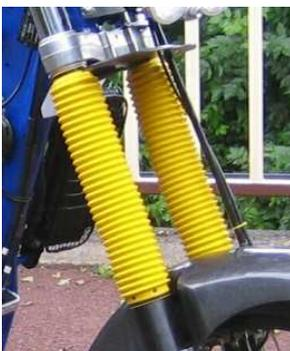
D'origine, tous les trails sont munis de soufflets que certains jugent disgracieux et retire. Même si l'on a monté des caches-poussière supplémentaires sur les tube de fourches, ces accessoires ne remplace pas l'efficacité des soufflets, lesquels empêchent poussière et boue d'aller ronger les joint spy. Il est donc impératif de munir la fourche de ces soufflets. Veillez à leur bonne fixation (petits collier bien serrés) sur la fourche. *(Photo Team Hessler)*
