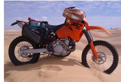
Par contre, veiller à ce que les sacoche soient soutenue par le bâti arrière du cadre et non par la boucle de cadre conçue pour supporter le garde boue arrière et un porte paquet sensé supporter un maximum de 5 kg...
